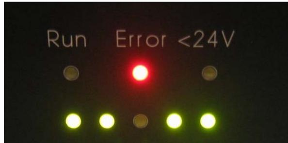
Die LED am rechten Rand entspricht dem Wert 1, die zweite LED von rechts dem Wert 2 usw. bis zur linken LED mit dem Wert 16.
