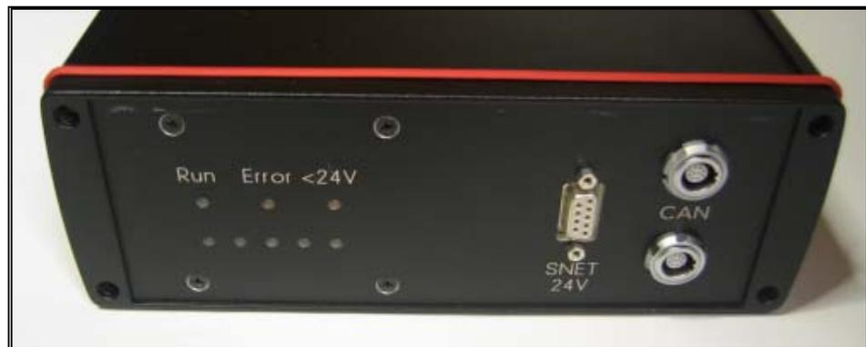
*Bild 2 SNET/CAN Konverter Frontseite*
